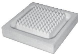
图 25 南安普顿大学制造的锥形阵列式发射极<sup>[55]</sup>
