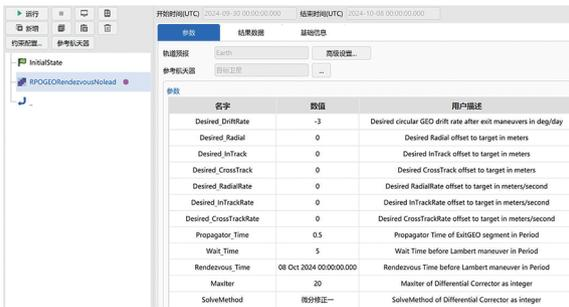
图 12 GEO 轨道交会基元参数输入界面
