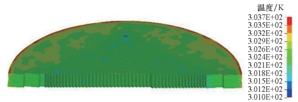
图7 典型落锤试验试样大变形温度云图
