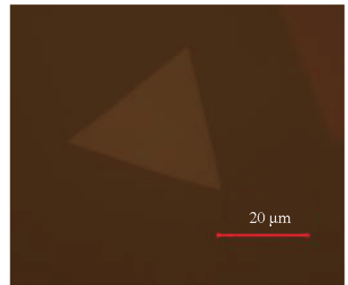
(b) 10.3\text{ nm} \alpha - \text{In}_2\text{Se}_3 纳米片的光学图像
