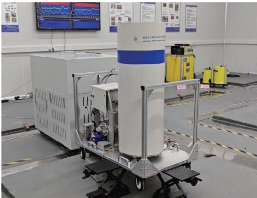
图 1 基准型量子绝对重力仪(型号 AG-ref) Fig. 1 Reference quantum absolute gravimeter (model AG-ref)
