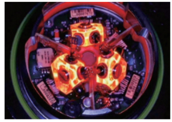
图 16 惯性测量单元中的战术级 GG1308 激光陀螺
