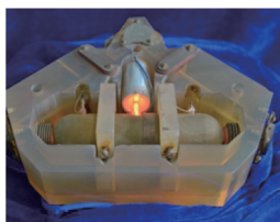
图 25 外腔型四频差动激光陀螺实验室样机
