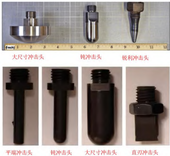
图3 冲击头形状和尺寸 [21-22]
