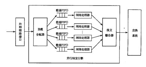
图 1 分布式并行转发引擎模型
