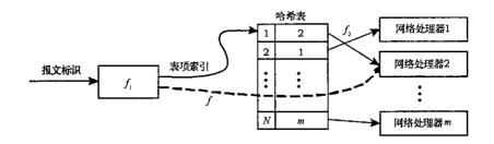
图 2 报文—网络处理器的间接映射方式
