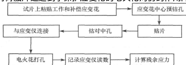
图 4 电火花小孔法残余应力改进方法的测量流程
