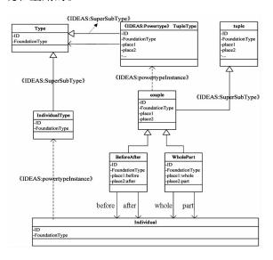
图 4 IDEAS 基础层本体元模型的 UML 描述 Fig. 4 The UML description of IDEAS foundation ontology meta-model
