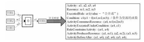
图 9 "合并或"模式 Fig. 9 OR fan-in pattern
