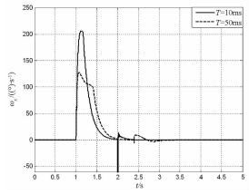
图 6 滚转角速率状态响应对比曲线
