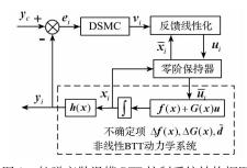
图 1 航弹离散滑模 BTT 控制系统结构框图 Fig. 1 Discrete-time sliding mode BTT control system structure diagram
