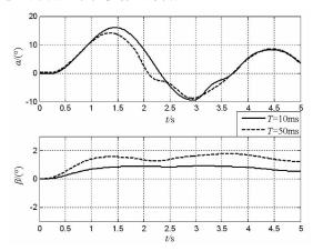
图 5 攻角与侧滑角状态响应对比曲线
