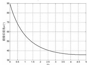
图 2 驱动杆匀速驱动时后掠角变化规律 Fig. 2 Actual sweepback angle history in 5s
