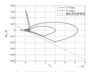
图 14 偏航通道滑模面相轨迹对比曲线
