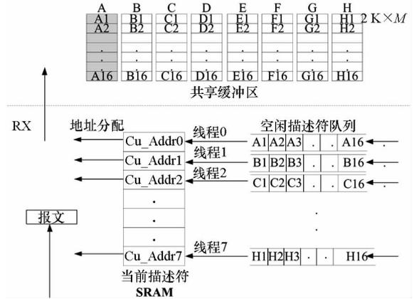
图 2 线程亲和缓冲区管理机制示意图
