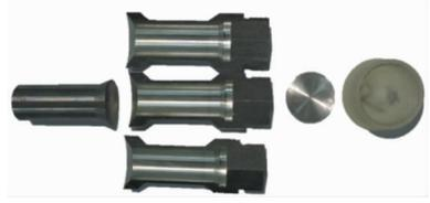
图 3 试验用弹体照片
