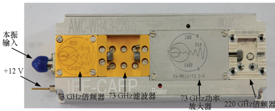
图 9 220 GHz 发射前端实物图
