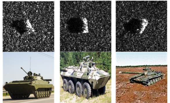
图7 BMP2、BTR70 和 T72 的 SAR 图像和光学图像
