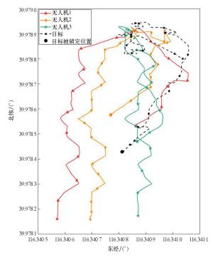
外场飞行试验中无人机和目标的移动路径
