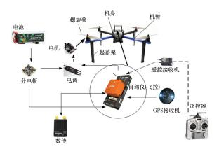
图 10 四旋翼无人机框架结构 Fig. 10 Quadrotor UAV frame structure
