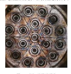
图 18 喷注面板烧蚀照片 Fig. 18 Erosion photo of injection panel
