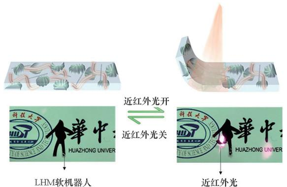
图5 高灵敏度光控软机器人<sup>[53]</sup>
