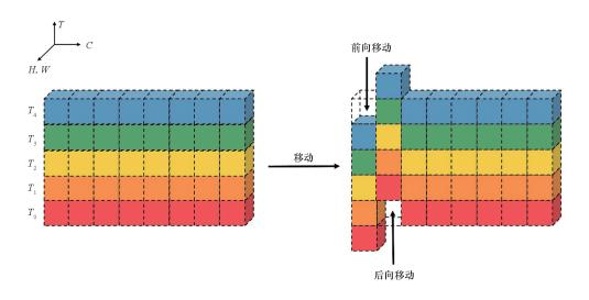
图 2 TSM 结构 Fig. 2 Architecture of TSM
