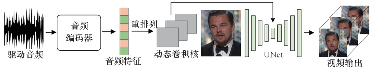
(d) 基于动态卷积核的视觉语音生成 [89] (d) VSG with dynamic convolution kernels [89]
