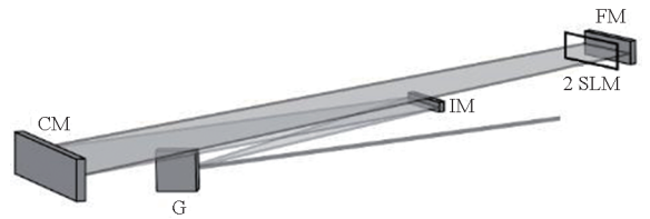
(a) 折叠式零色散光路结构 (几乎无光学像差)
