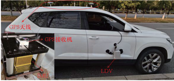
图 4 实验设备安装
